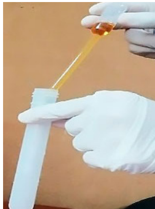
Figura 4. Agregado de 5 ml de Aceite al Tubo#1 (Tapa Negra) N-OIL 50
