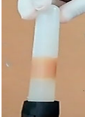
Figura 11. Separación entre la solución acuosa y aceite del Tubo #1 (Tapa negra)
