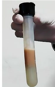
Figura 34. Solución resultante, parte inferior de capa acuosa clara y parte superior de Aceite
